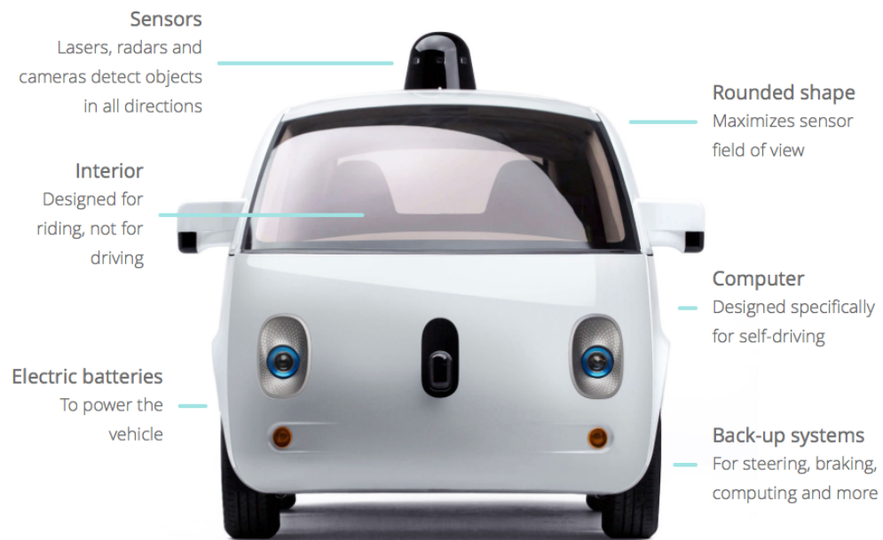
Bild vom aktuell neuesten Modell des Google Cars mit Sensoren und Funktionen 29
